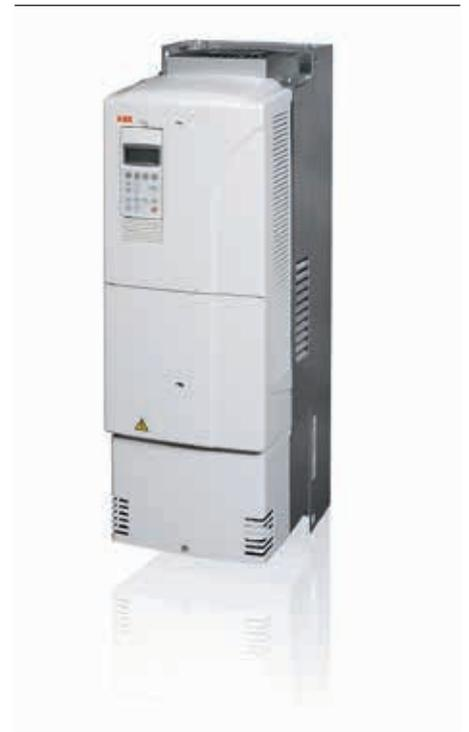
de distorsion harmonique de courant à moins de 5%. Dans ce cas, le pont redresseur n'est pas constitué de diodes mais de transistors IGBT (→ p. 58 de ce numéro d'ABB review) qui modulent et lissent la forme d'onde.
