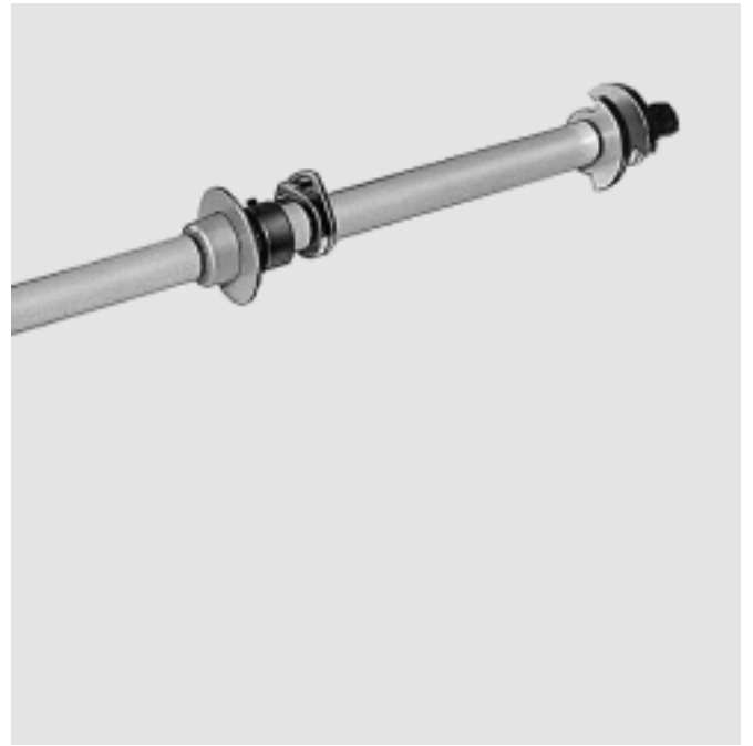
Figura 5/15: Cuando por motivos de transporte las cajas superpuestas no vayan montadas, el árbol de accionamiento del seccionador de puesta a tierra se adjunta suelto. La figura muestra el seccionador en posición „desconectado (DES)“, con elementos de accionamiento dispuestos para el funcionamiento
