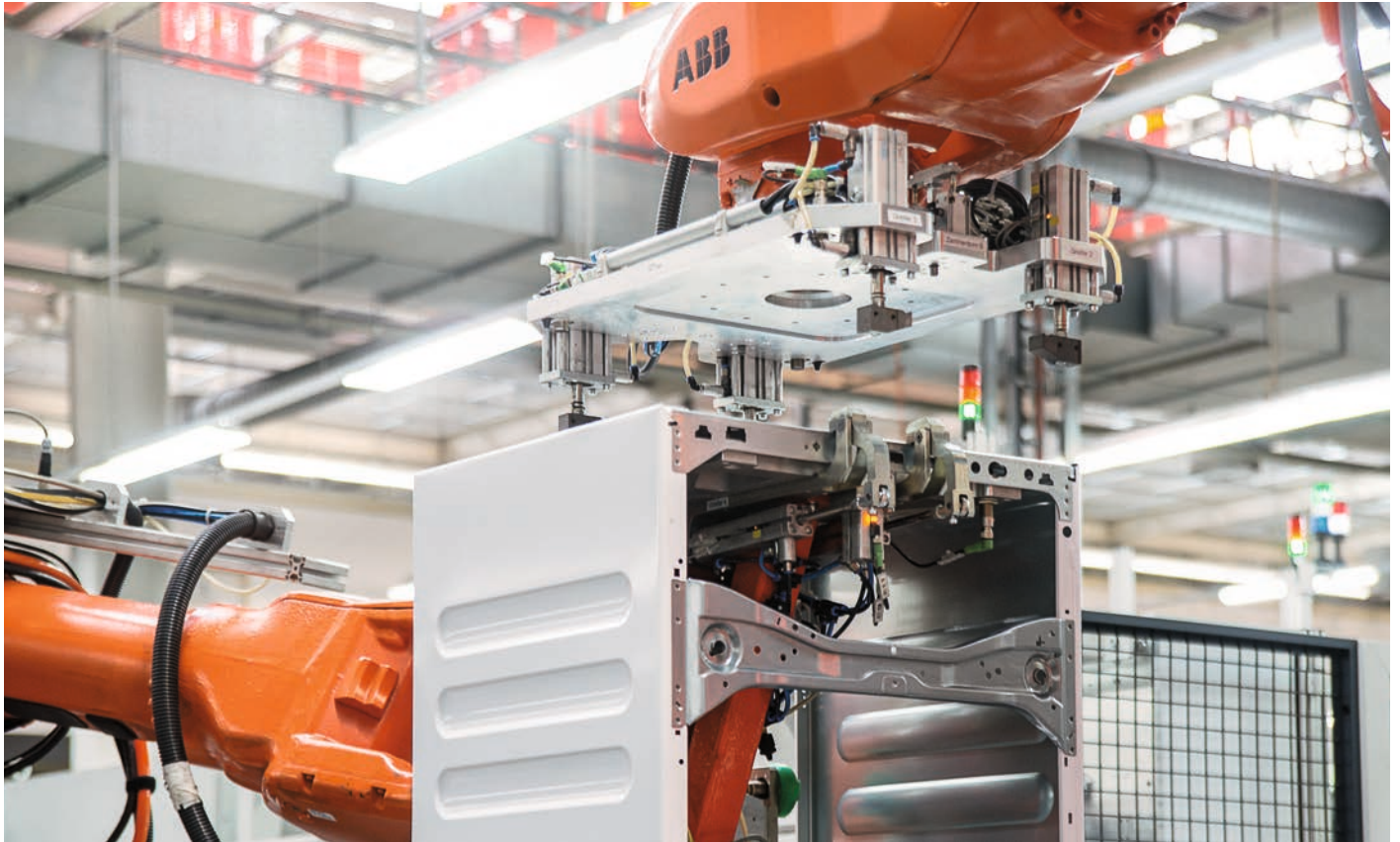
Die Taktzeit für die Gehäusefertigung der neuesten Waschmaschinen- generation von Miele beträgt 49,5 s.
