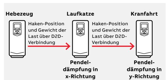
Die Frequenzumrichter kommunizieren über eine D2D-Verbindung. Die Position des Hakens kann auch über den Feldbus oder eine analoge Kommunikation übermittelt werden.
