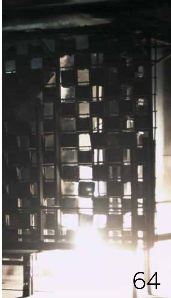
Atténuer l'impact d'un arc interne
