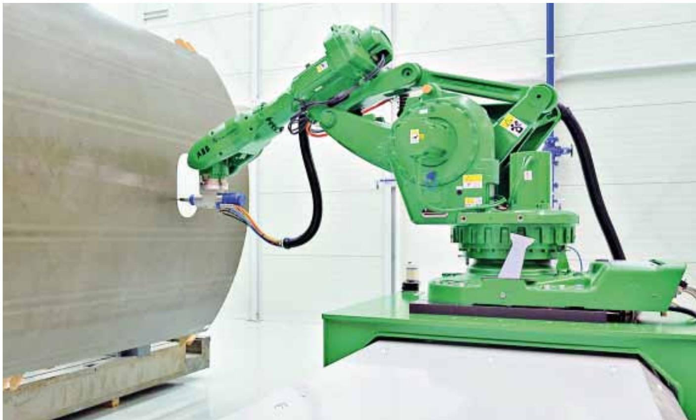
Fräsbearbeitung einer CFK-Flugzeug-Schalenstruktur mit einem IRB 6660-Bearbeitungsroboter
