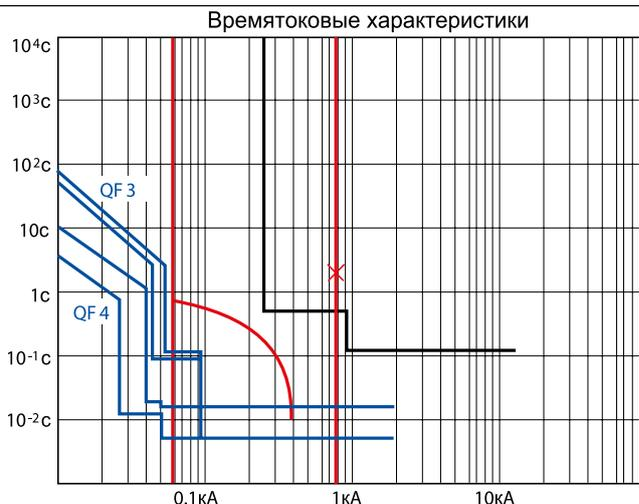
Для обеспечения селективности между QF3 и QF4, необходимо установить функции L и S выключателя Т4 следующим образом: QF3 Т4Н 320 PR222DS/P-LSI In 320А
