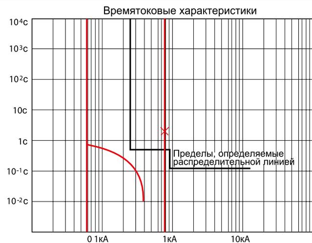
Кроме защиты трансформатора, кривая вводного автоматического выключателя НН должна также обеспечивать селективность автоматических выключателей НН. Следовательно, можно построить кривые автоматических выключателей НН для того, чтобы определить минимальный предел кривой вводного автоматического выключателя:
