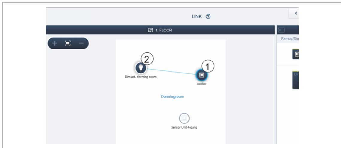
Fig. 20: Forbindelse af aktuator og sensor
