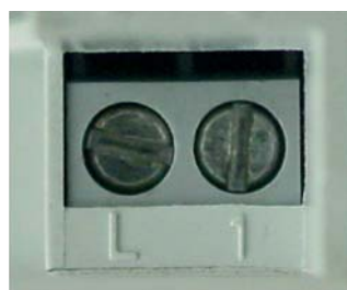
Abbildung 4. Anschlussklemme des Modbus-Port
