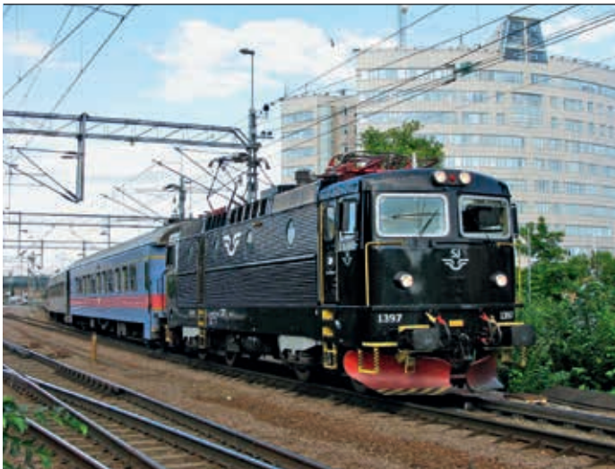
5 La locomotive Rc des chemins de fer suédois SJ utilise des thyristors ASEA (1967).
