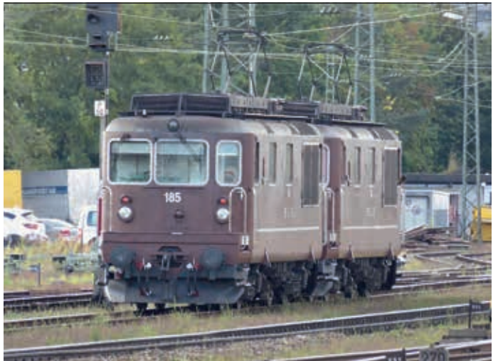
4 La locomotive Re 4/4 des chemins de fer suisses BLS embarque des diodes BBC (1964).
