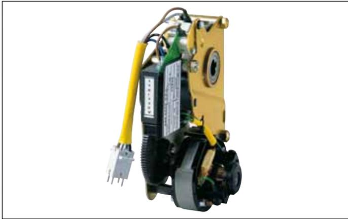
Este comando realiza o carregamento automático das molas de fechamento do comando do disjuntor. Depois do fechamento do disjuntor, o motor de engrenagens realiza o carregamento imediato das molas de fechamento. Na ausência de tensão de alimentação ou durante os serviços de manutenção, as molas de fechamento podem ser recarregadas manualmente (por intermédio da alavanca própria incorporada no comando).
