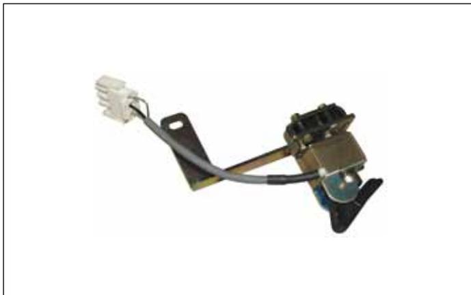
O solenoide de abertura (MO3) é um relé especial com desmagnetização. Está situado no comando (no lado esquerdo) e não é alternativo ao relé de abertura suplementar (-MO2). Em primeiro lugar, é necessário verificar a utilização deste relé especial com dispositivos de proteção contra a máxima corrente diferentes de PR521 e PR512.
