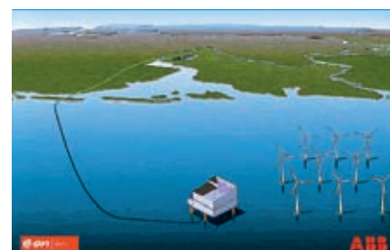
8 HVDC Light 可实现海上大型风电场最佳并网。
