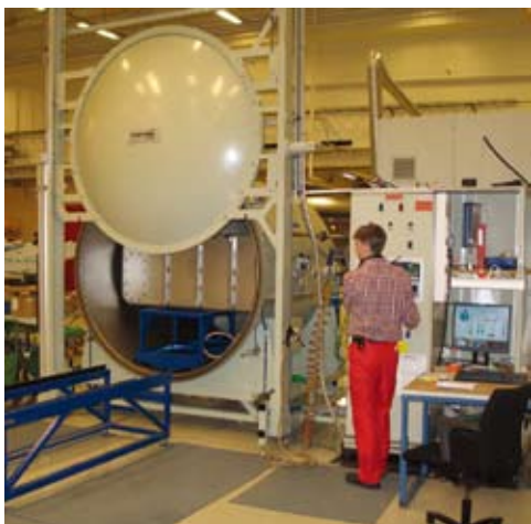
用于气体检漏试验和SF 6 充填的真空罐
