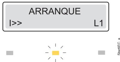
Fig. 4.3.2.1.-1 Indicación de arranque bloqueado
