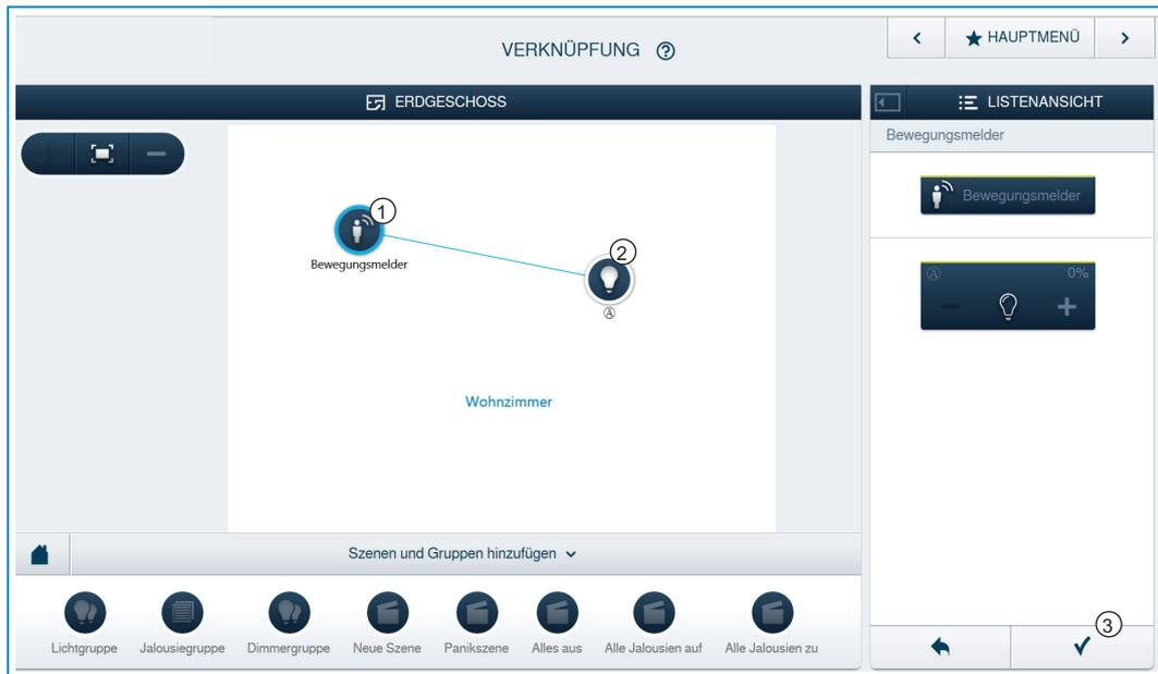
Abb. 12: Aktor und Sensor verbinden
