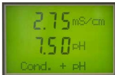
Mesure simultanée de conductivité et de pH
