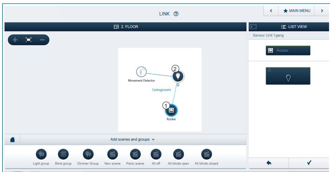
Fig. 15: Enlazar el actuador y el sensor
