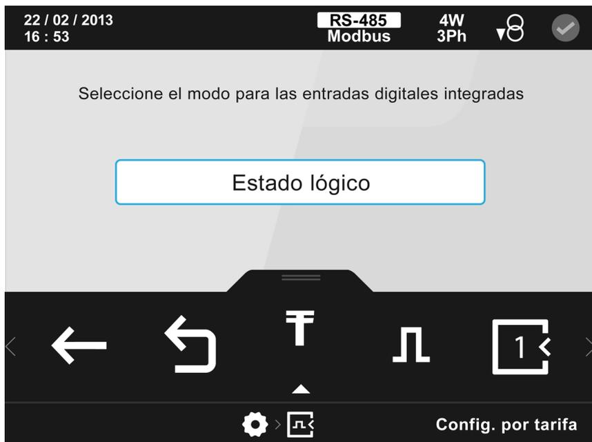
Figura 133: Pantalla principal de la configuración de las entradas digitales
