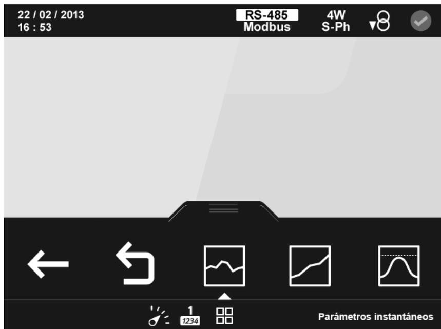
Figura 28: Pantalla de visualización de parámetros por defecto ( visualizar 1 parámetro).
