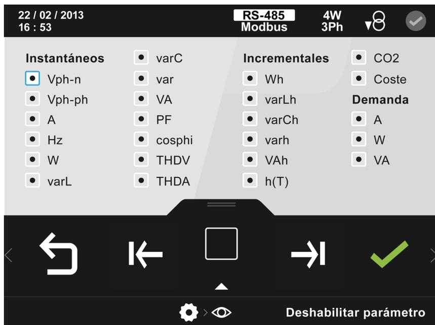
Figura 121: Pantalla de configuración de la visualización de variable
