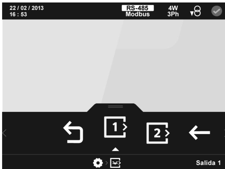
Figura 130: Pantalla principal de la configuración de las salidas digitales de transistor .
