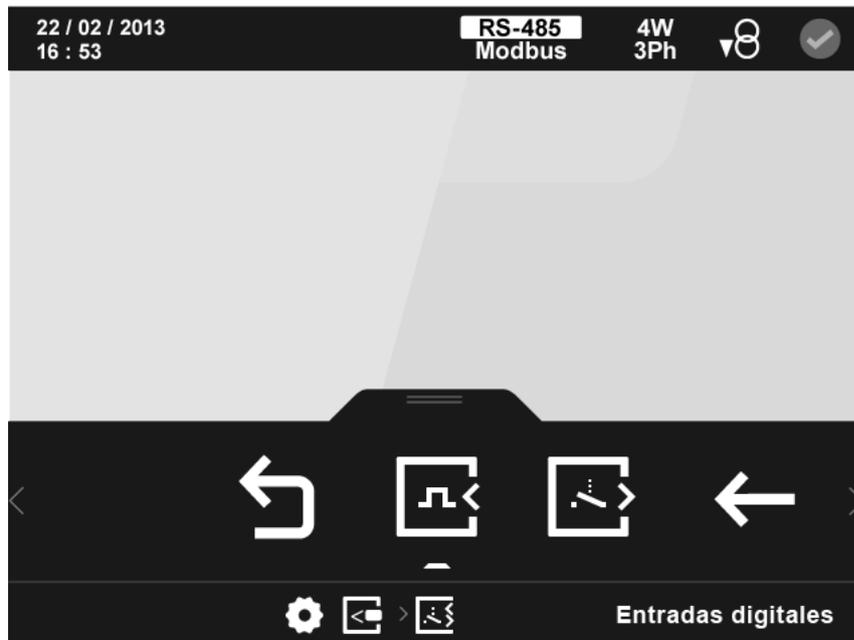
Figura 155: Pantalla principal de la configuración de las entradas/salidas digitales de relé
