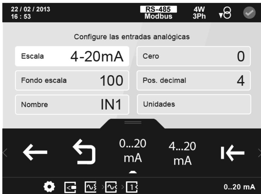
Figura 174: Pantalla de configuración de las entradas analógicas
