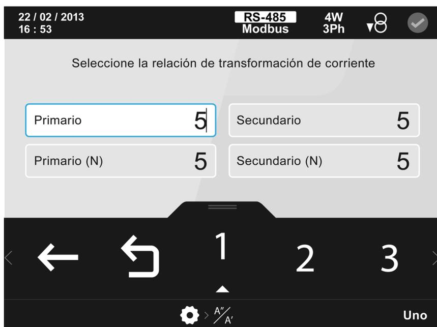
Figura 120: Pantalla de configuración de la relación de los transformadores de corriente
