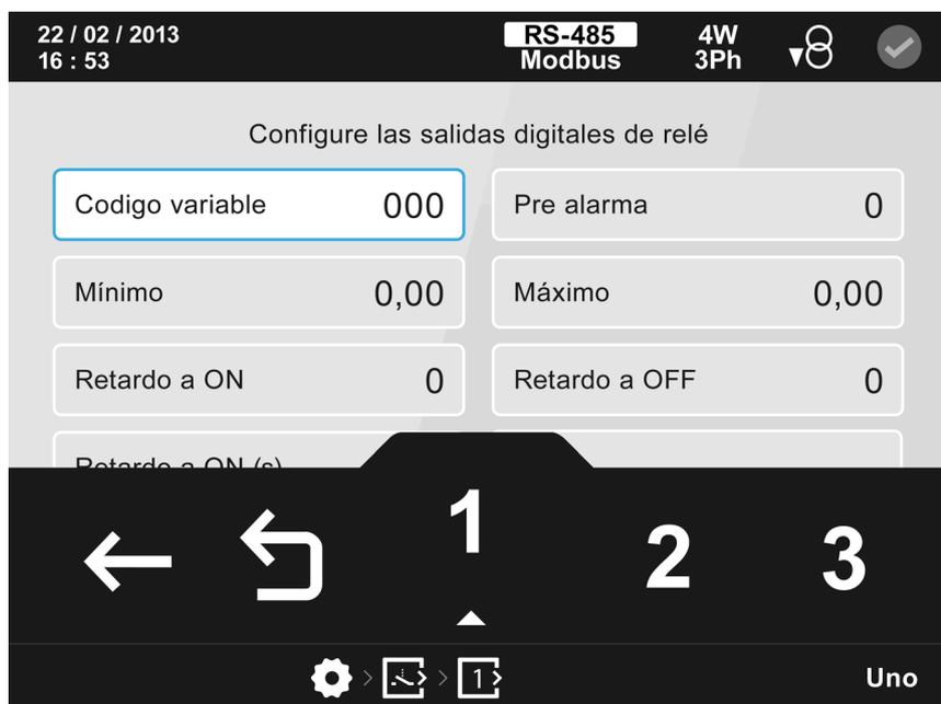
**Figura 129:** Pantalla de configuración de las salidas digitales de relé
