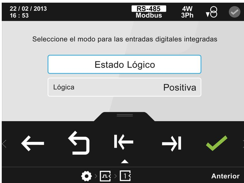
Figura 136: Pantalla de configuración de las entradas digitales ( modo estado lógico)
