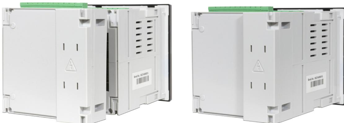
**Figura 147: Conectar el módulo de expansión.**
