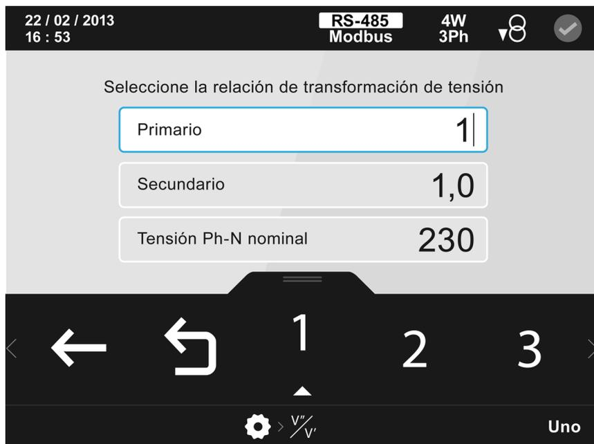
Figura 119: Pantalla de configuración de la relación de los transformadores de tensión
