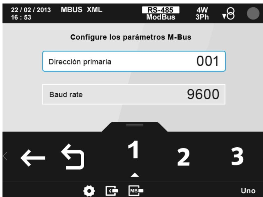
Figura 202: Pantalla de configuración del módulo MBus
