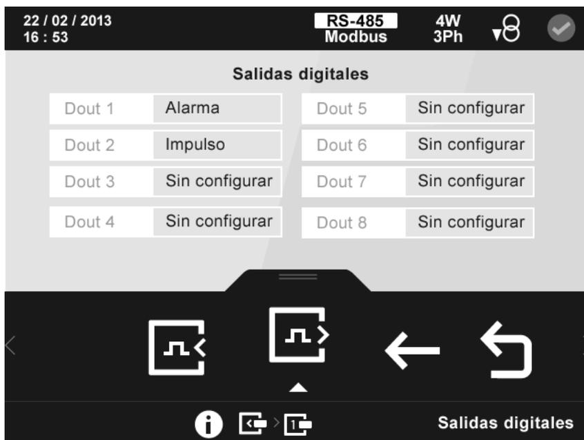
Figura 100: Pantalla de información de las salidas digitales (Módulo Entradas/Salidas digitales de Transistor)
