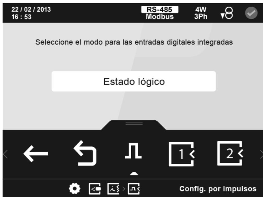
**Figura 156:** Pantalla principal de la configuración de las entradas digitales de relé
