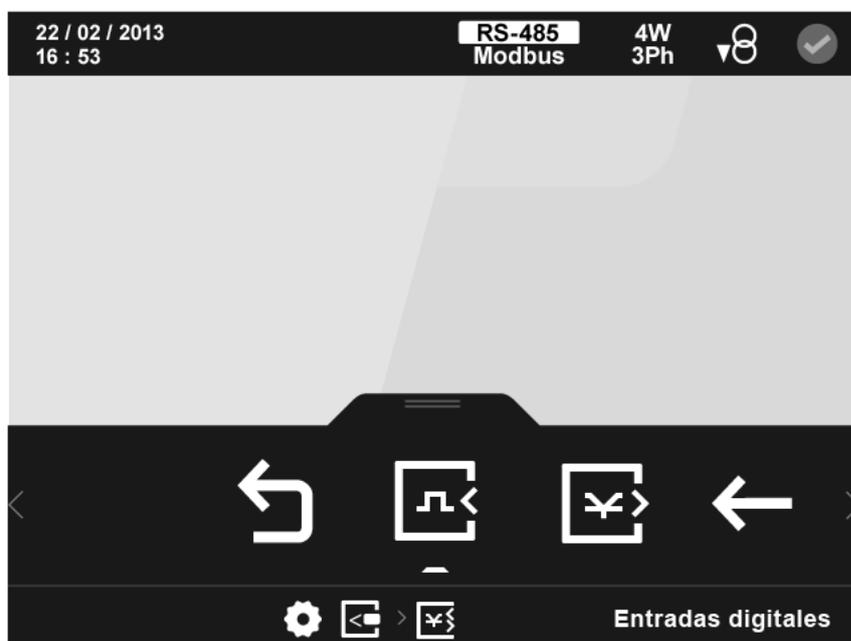
Figura 164: Pantalla principal de la configuración de las entradas/salidas digitales de transistor .
