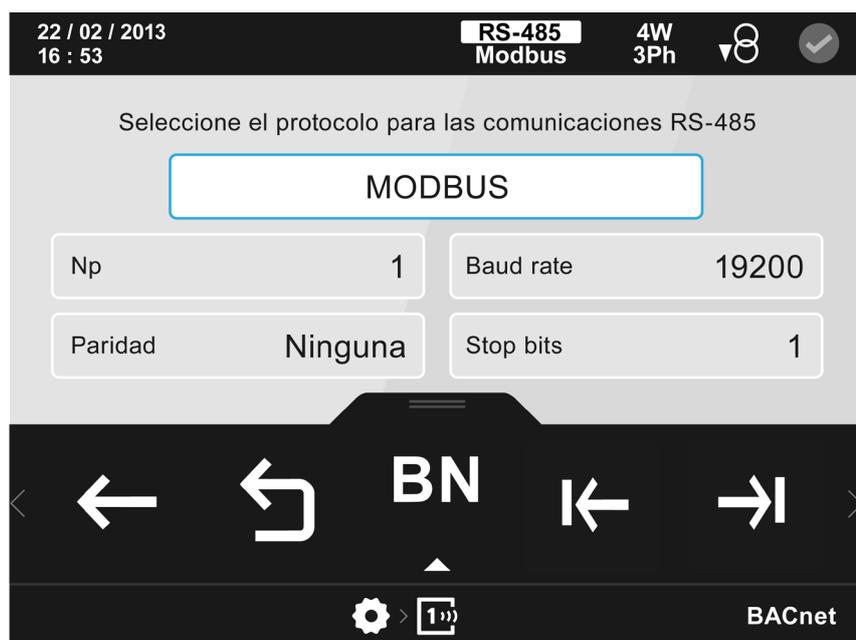
Figura 137: Pantalla de configuración de las comunicaciones integradas ( protocolo Modbus)
