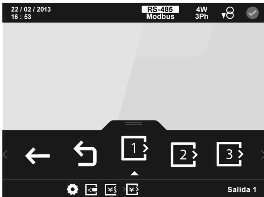
Figura 165: Pantalla principal de la configuración de las salidas digitales de transistor .
