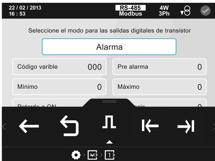
Figura 131: Pantalla de configuración de las salidas digitales de transistor ( modo alarma)
