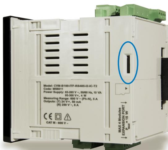
Figura 211: Posición de la ranura con la microSD.
