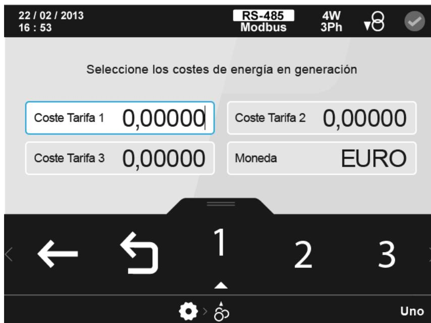
Figura 125: Pantalla de configuración de los costes de energía en generación
