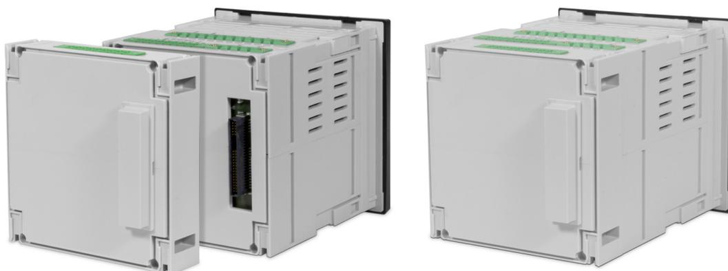
**Figura 143:** Conectar el módulo de expansión.
