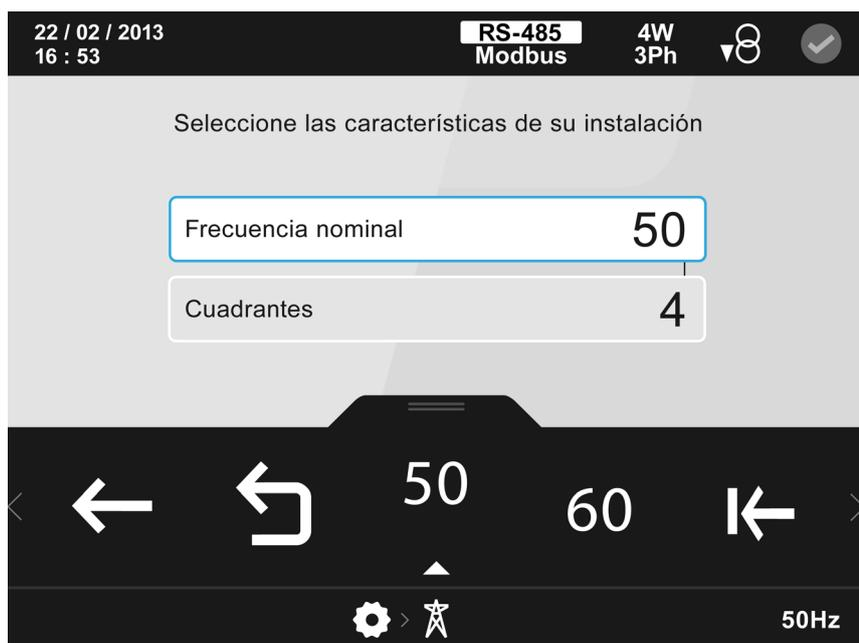
**Figura 123:** Pantalla de configuración de las características de la instalación
