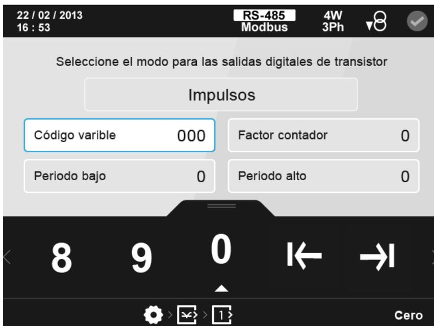
Figura 132: Pantalla de configuración de las salidas digitales de transistor ( modo impulsos)
