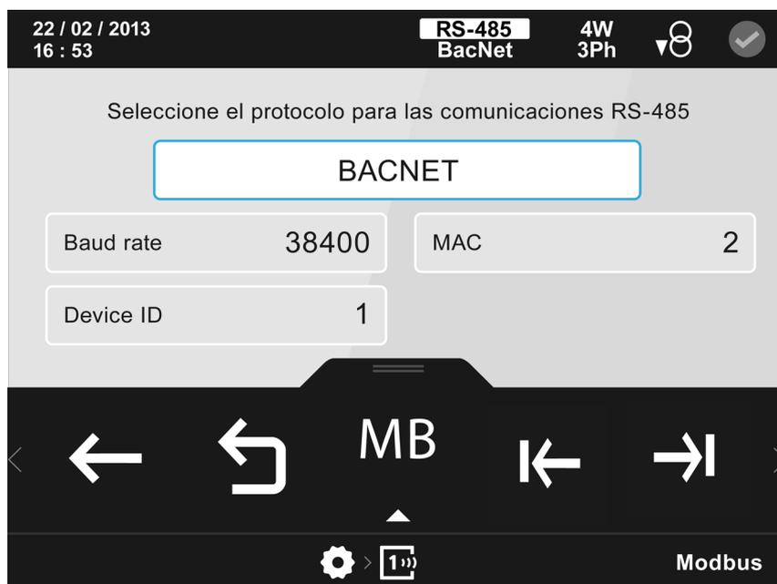
Figura 138: Pantalla de configuración de las comunicaciones integradas ( protocolo BACnet)
