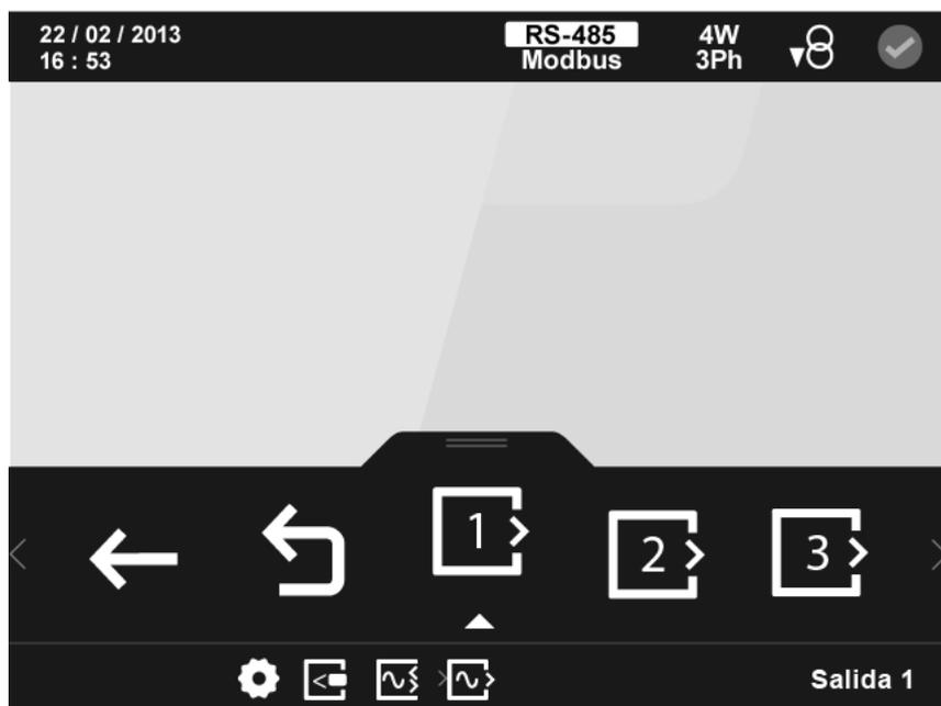
**Figura 175:** Pantalla principal de la configuración de las salidas analógicas
