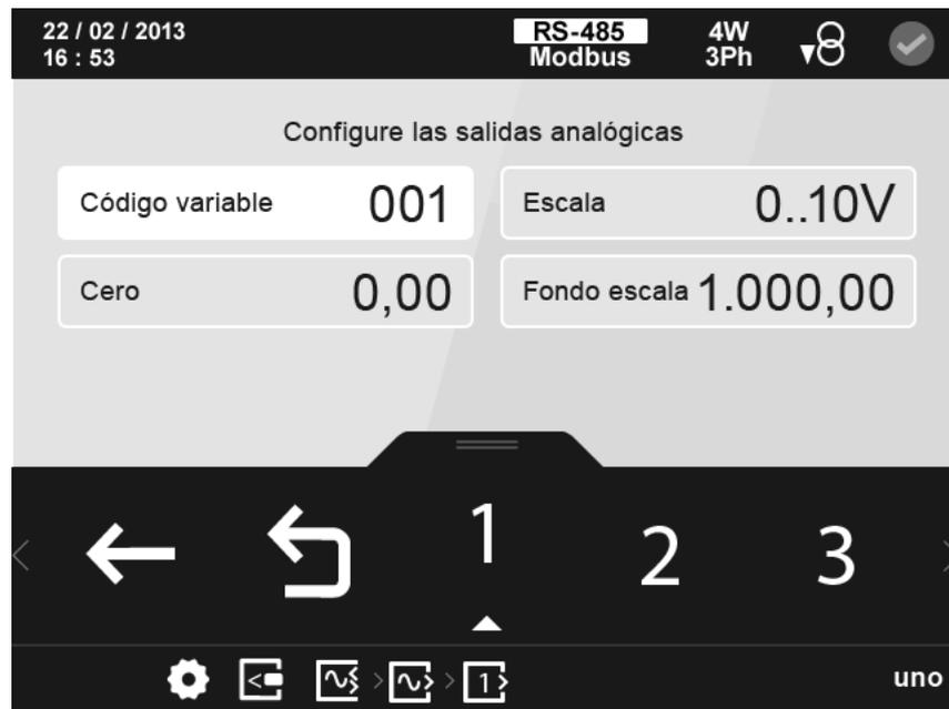
Figura 176: Pantalla de configuración de las salidas analógicas
