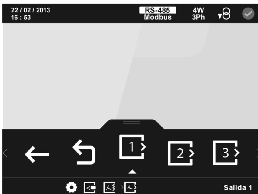
Figura 157: Pantalla principal de la configuración de las salidas digitales de relé
