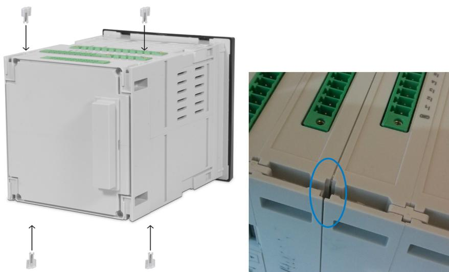
**Figura 144:** Introducir los clips de sujeción en las ranuras correspondientes.
