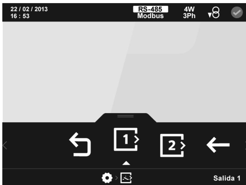
Figura 128: Pantalla principal de la configuración de las salidas digitales de relé
