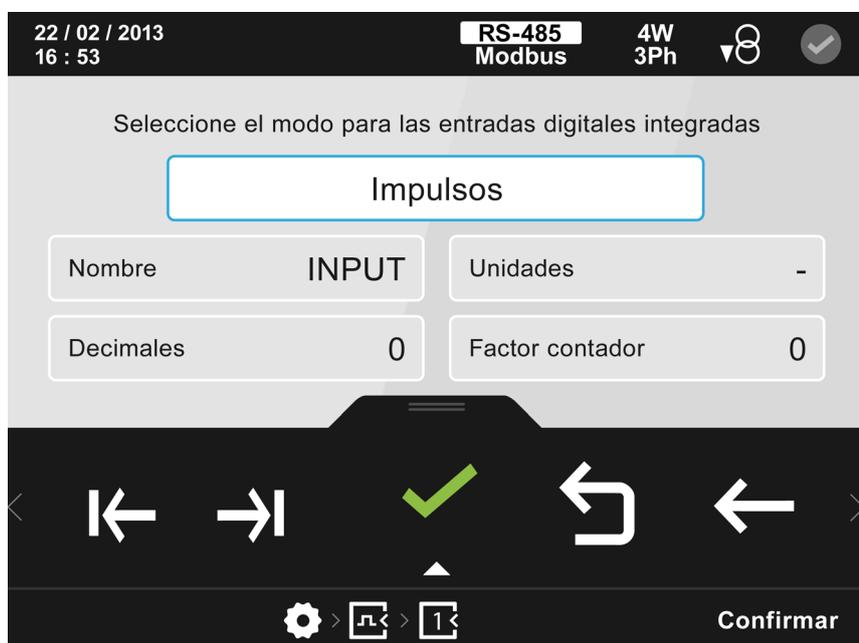
Figura 135: Pantalla de configuración de las entradas digitales ( modo impulsos)
