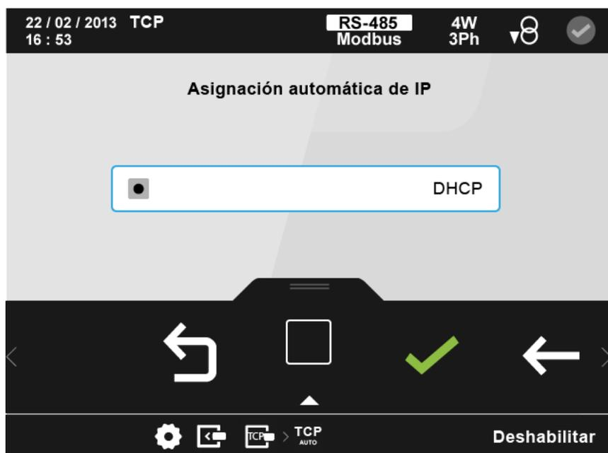
**Figura 183:** Pantalla de configuración del módulo Modbus TC (Bridge) (TCP Auto)
