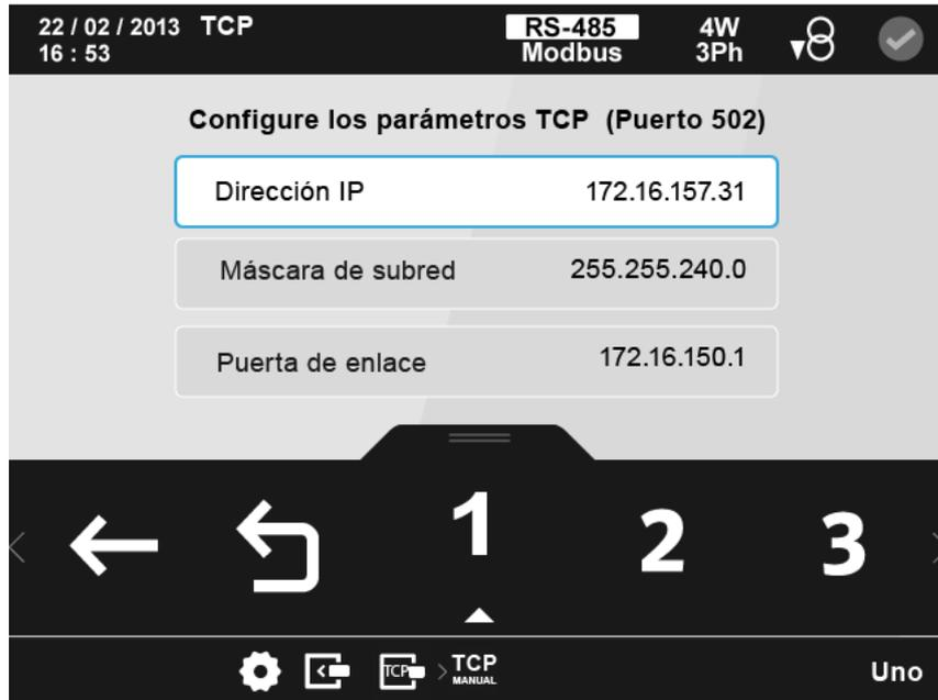
Figura 184: Pantalla de configuración del módulo Modbus TC (Bridge) (TCP manual)
