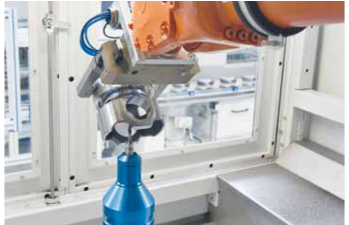
Neben dem Be- und Entladen erledigen die Roboter auch das Entgraten der Kolben.
