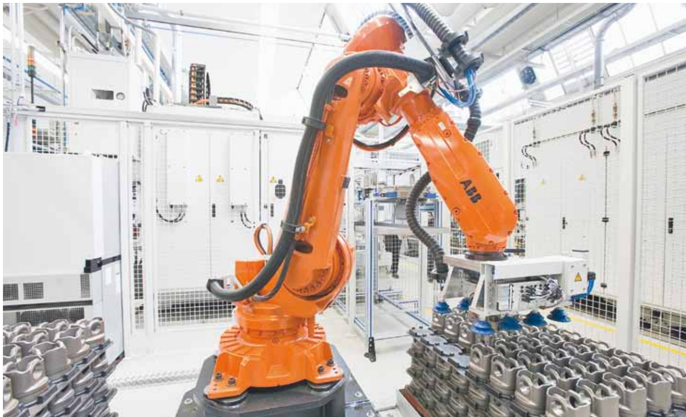
Ein IRB 6620 ist in der Depalettier-/Palettierzelle im Mahle-Werk Rottweil im Einsatz.
