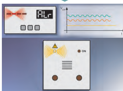
Традиционное устройство контроля изоляции
