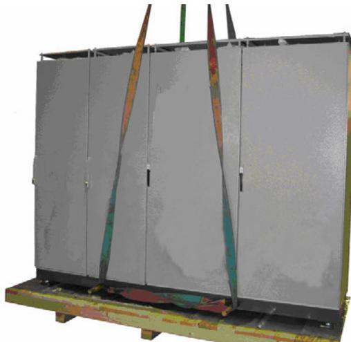
Figure 2: Lifting DYNACOMP cubicles mounted on a base frame 图 2：吊装固定在基架上的 DYNACOMP 单元
