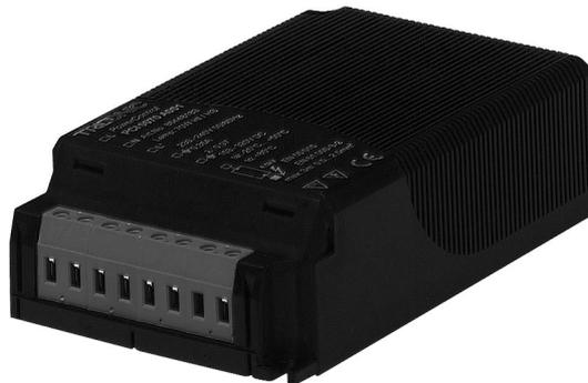
Der digitale Baustein im EVG-HI steuert den Leistungskreis, die Zündung und die optimale Funktion der optionalen Zündzeitüberbrückung. EVG-HI ist für **Halogen-Metaldampflampen** und **Natriumdampf-Hochdrucklampen** mit 4 – 5 kV Zündspannung geeignet. Die EVG-HI bieten wesentliche Vorteile gegenüber konventionellen Vorschaltgeräten:
