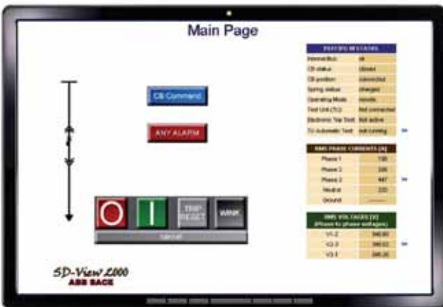
Figura 33: Ventana gráfica principal de un interruptor abierto Emax
