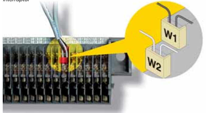
Figura 26: Conexión del cable principal directamente a los bornes del interruptor
