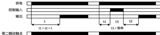
该功能需要模块有持续的控制供电电压用于计时。当模块有供电电压后就开始计时, 等设置的延时时间结束后, 输出继电器动作。计时可以被控制信号暂停。前面完成的时间t1可以存储起来, 当控制信号断开后计时继续。若供电电压中断, 则输出继电器复位, 延时计时清零。
