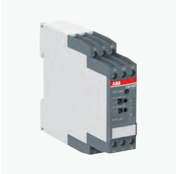
CM-IWS.1符合IEC 61557-8标准, 用于监视电压最大为250 V AC和300 V DC不接地IT交流系统、或带电气连接的DC回路的IT交流系统、或是不接地IT直流系统的绝缘电阻的监视。它可以根据应用要求进行设置, 因此具有多种用途。该产品有两种不同连接端子的版本, 您可以选择成熟的双接线孔螺钉连接端子或完全无需工具的双接线孔插入式快速连接端子。
