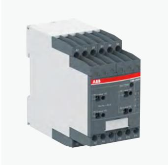
CM-IWN.1符合IEC 61557-8标准, 用于监视电压最大为400 V AC和600 V DC不接地IT交流系统、或带电气连接的DC回路的IT交流系统、或是不接地IT直流系统的绝缘电阻的监视。可通过连接耦合模块CM-IVN, 把测量范围扩展到690 V AC和1000 V DC。它可以根据应用要求进行设置, 因此具有多种用途。CM-IWN.1有两种不同的端子型号, 您可以选择成熟的双接线孔螺钉连接端子或完全无需工具的双接线孔插入式快速连接端子。
