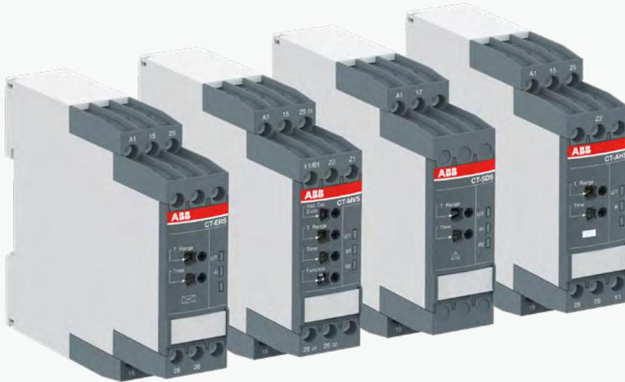
先进的CT-S系列包括22个单一功能模块和16个多功能模块（最多有13个功能），有7到10个时间范围，可在0.05秒和300小时之间进行时间调节。每个设备都支持两种不同的连接技术，即双接线孔螺钉连接端子和ABB的抗振双接线孔插入式快速连接端子。
