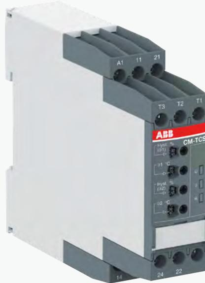
CM-TCS系列的温度监视继电器能够连接PT100传感器测量固体、液体和气体介质的温度。所有模块均可设置过温和欠温监视，以及开路或闭路原则。一旦温度低于或超过设定的阈值，输出继电器就会改变其状态，并且前面板LED将显示当前状态。
