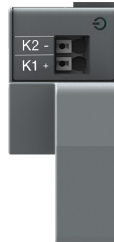
Şek. 5.8 OXEA1 yardımcı güç kaynağı modülü sinyalleri
