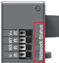
Şek. 5.18 Ekip Com DeviceNet modülü sinyalleri
