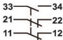
Kontaktblock – Konfiguration 2 NC, 1 NO
