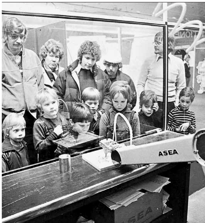
3 Der IRB-6 mit 5 Achsen und 6 kg Tragkraft wurde 1974 vorgestellt. Viele der 1.900 gebauten Roboter sind heute noch in Betrieb.
