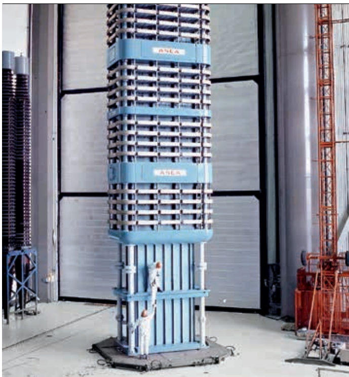
2 Ein Thyristorventil aus den frühen 1980er Jahren für die HGÜ Inga-Shaba in Zaire (heute Demokratische Republik Kongo)
