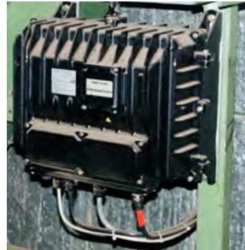
Abbildung 2: Beispiel: Elektronikeinheit EBN861
