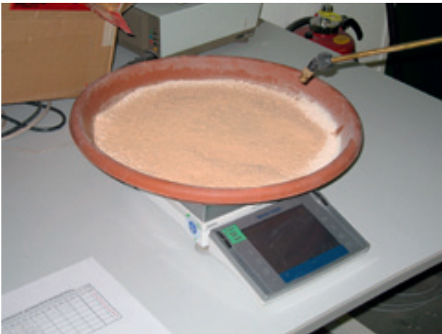
5 Tray containing sample material placed on a scale while spraying water across the sample Auf einer Waage platzierte Schale mit Probenmaterial, das mit Wasser besprüht wird
