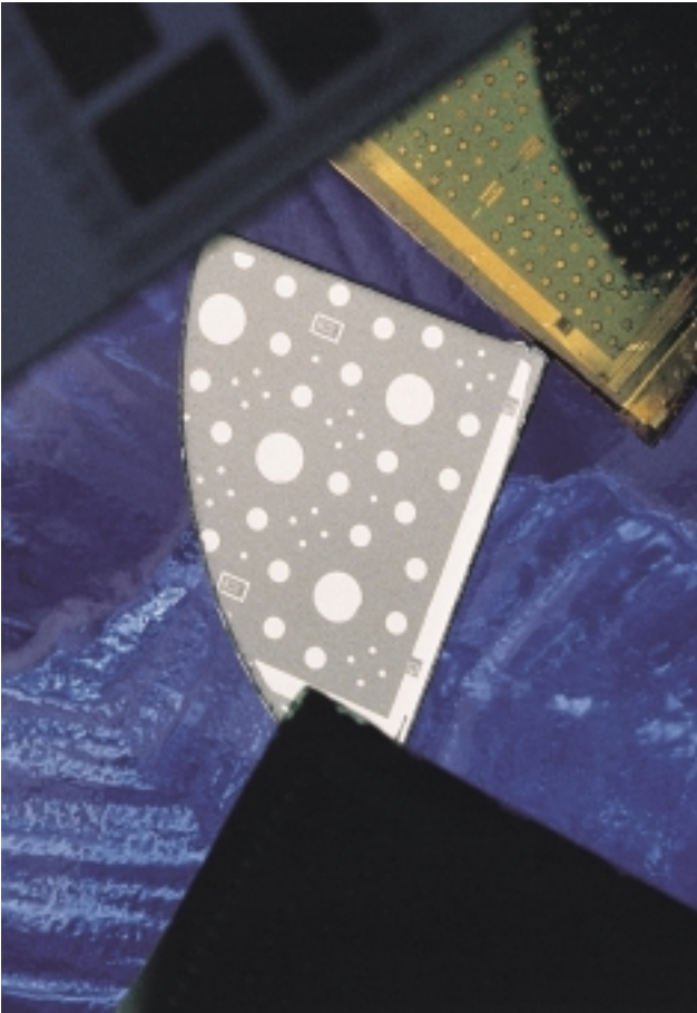
Substratos experimentales SiC (wafers) de distintas dimensiones con estructura de diodos
