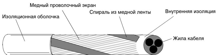
Рис. 1 Минимальные требования в отношении экранирования кабеля электродвигателя (например, кабели МСМК, НК)
