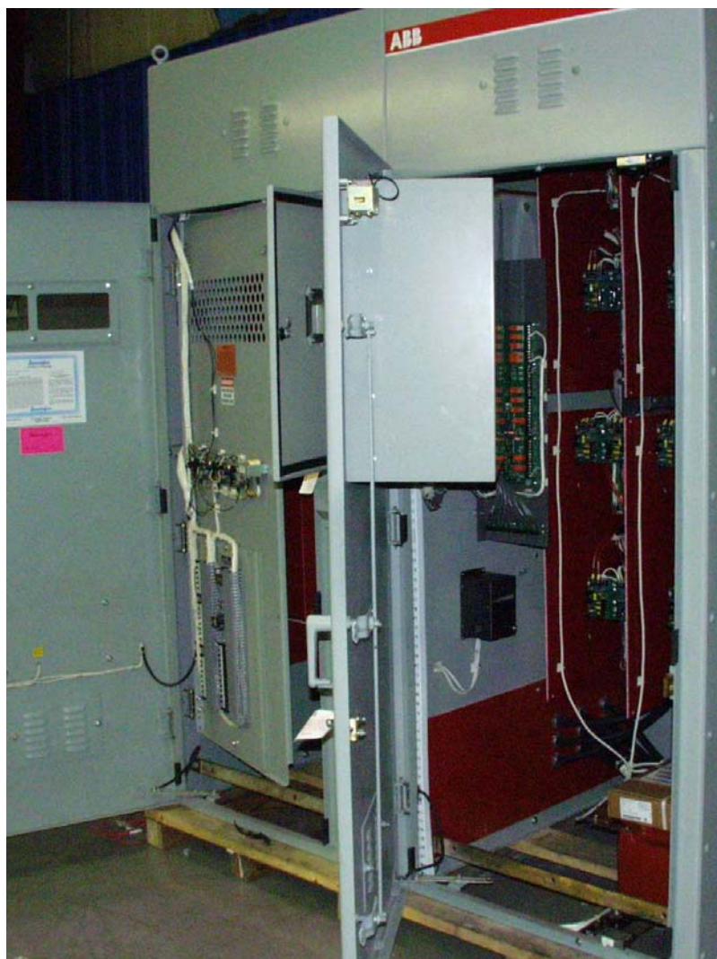
УПП типа SSM60800-E (6.0 кВ; 800А).
