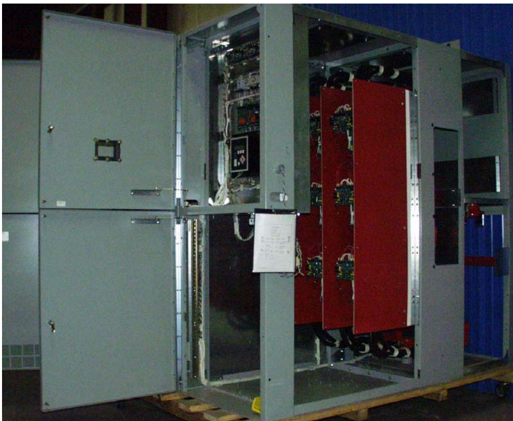
УПП типа SSM661200-E-S (6.6 кВ; 1200А). В задней части шкафа видны подводы шин, затребованные в техни- ческом задании.
