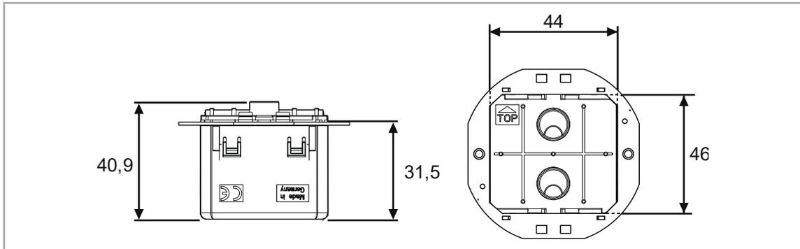
Abb. 3: Abmessungen (alle Maße in mm) aller beschriebenen Gerätetypen
