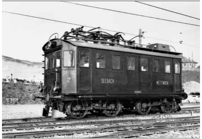
4 MFO-Versuchslok Nr. 2 mit Einphasen-Antriebsmotoren
