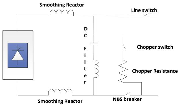
Figure 8, rectifier DC chopper
