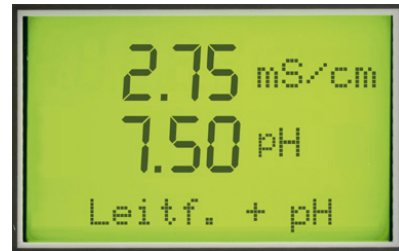
Gleichzeitige Leitfähigkeits- und pH-Messung
