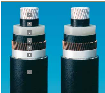
4 Constitution d'un câble HVDC Light extrudé en polymère
