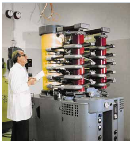
Una de las primeras válvulas de vapor de mercurio para la transmisión HVDC
