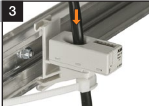
3 CMS-1xxDR, CMS-2xxDR: Kabel durch die Öffnung in das Gerät einführen. Bei Bedarf die Leitung mit Kabelbinder fixieren.
