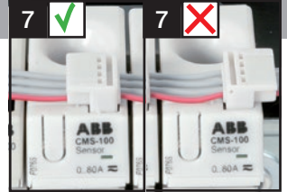
Steckverbinder an den Sensoren mit längerer Seite nach links montieren
