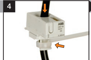
4 CMS-1xxCA, CMS-2xxCA: Kabel durch die Öffnung des Sensors einführen. Sensor mit Kabelbinder an Kabel befestigen.
