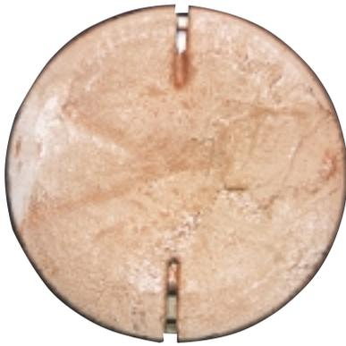
**9 Surface des contacts d'un système bipolaire après plusieurs coupures du courant de court-circuit (63 kA; diamètre des contacts: 100 mm)**
