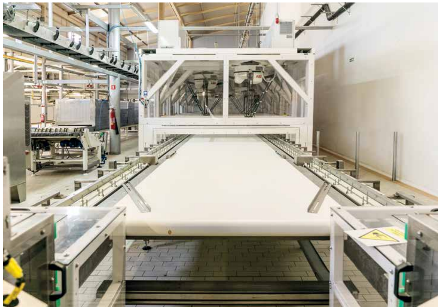
Zastosowany system wizyjny oraz blistry podawane równocześnie z dwóch stron umożliwiają równomierny podział pracy pomiędzy poszczególnymi manipulatorami na linii, dzięki czemu wszystkie urządzenia są równo obciążone.
