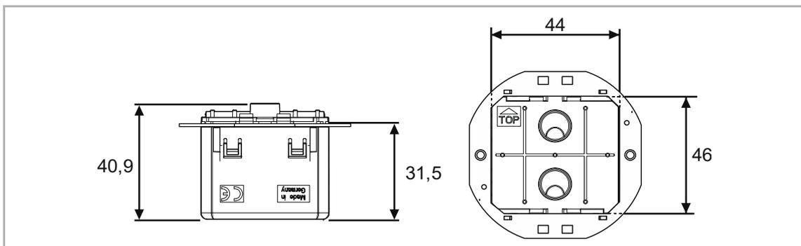
Abb. 3: Abmessungen (alle Maße in mm) aller beschriebenen Gerätetypen
