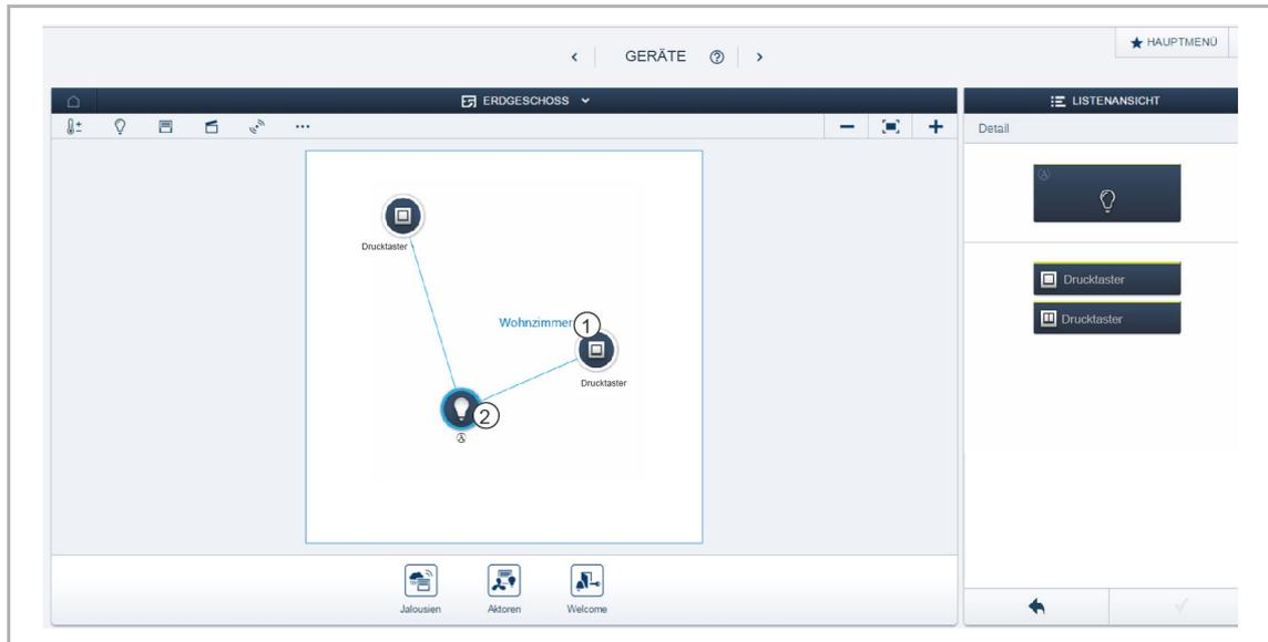
Abb. 16: Aktor mit einem weiteren Sensor verknüpfen
