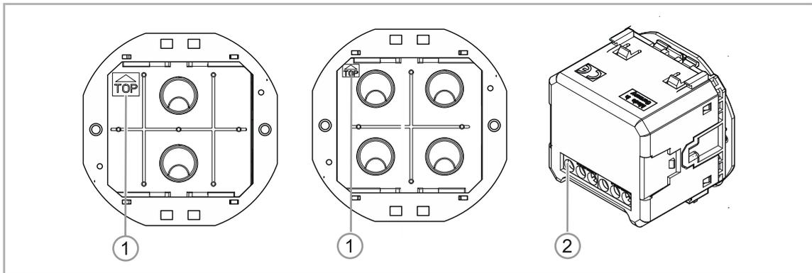
Abb. 2: Geräteübersicht Sensoreinheit 1-fach; 2-fach, wireless
