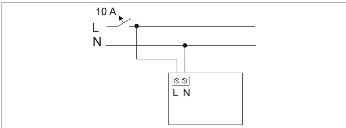
Abb. 4: Elektrischer Anschluss
