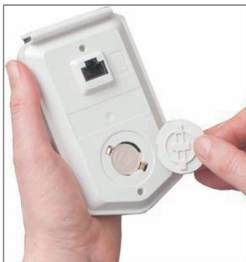
注：如需更换 ZCU-12（供电控制单元）电池，请联系本地 ABB 代表处。
