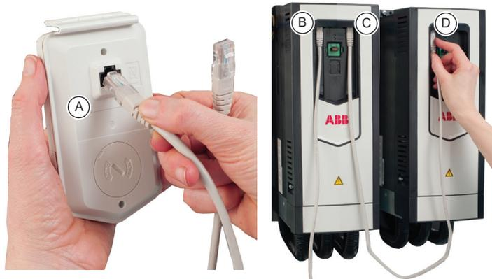
此图为 ACS880-01 变频器控制盘总线示例。ACX580 和 ACX480 变频器具有带两个 RJ-45 插槽的专用控制盘总线适配器。
