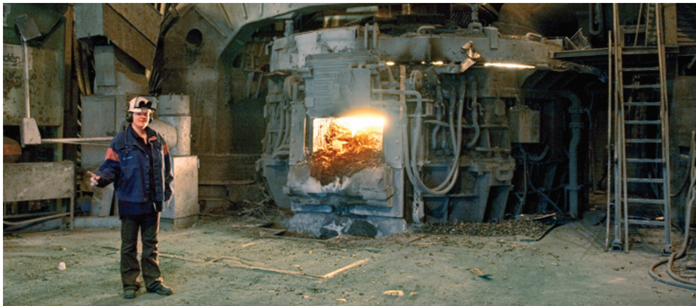
70 ton electric arc furnace, Uddeholms AB
