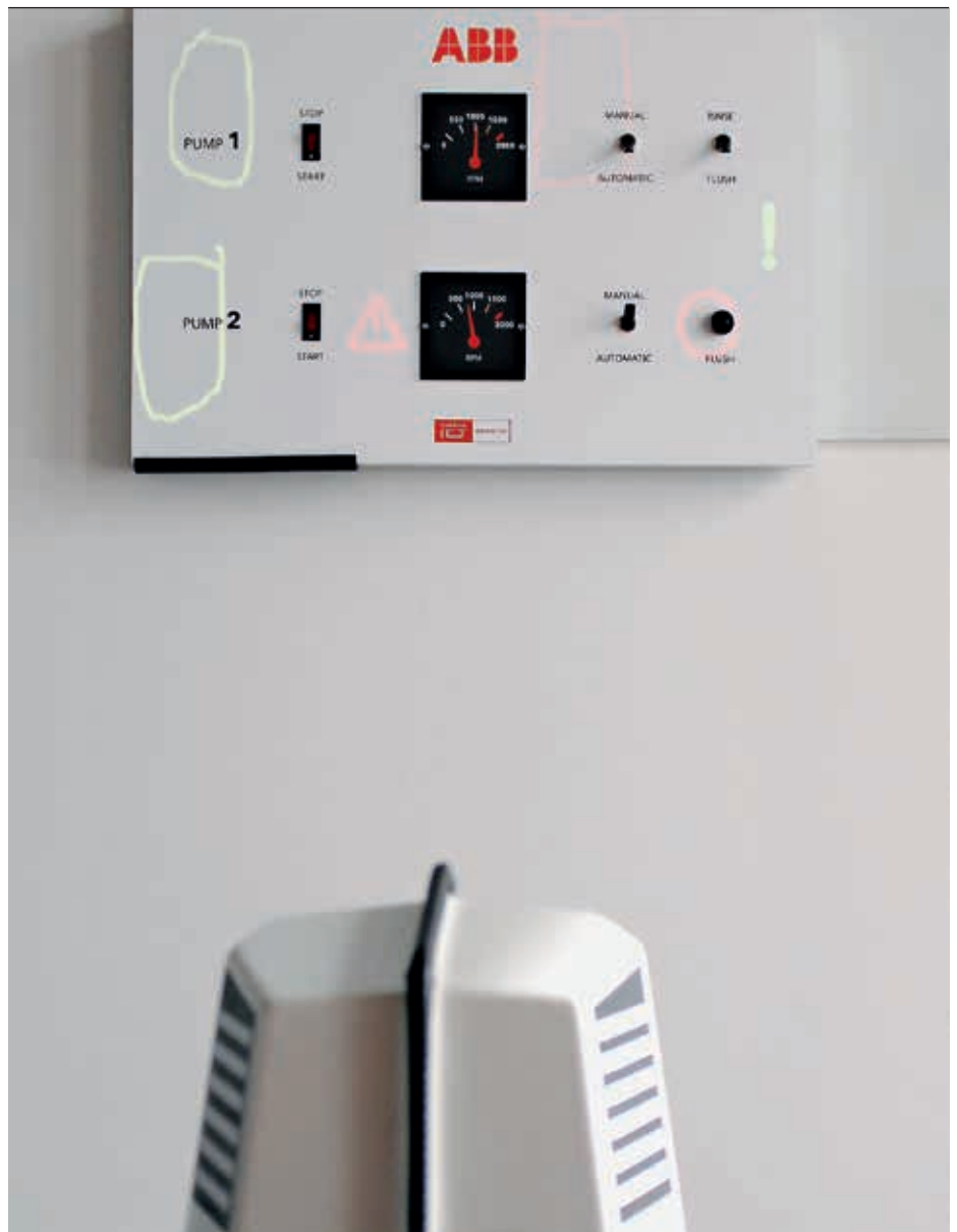
2 Der Projektor des Roboters zeigt die Anmerkungen des Experten auf dem betreffenden Objekt.
