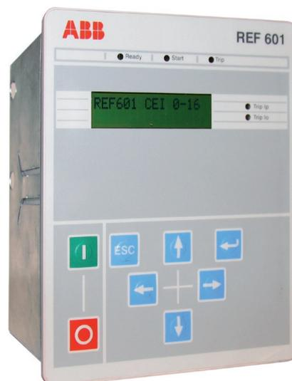
Il dispositivo di protezione REF 601 ha i pulsanti per comando elettrico di apertura e di chiusura interruttore; il comando elettrico di apertura è sempre operativo perché l'interruttore HD4/R è fornito di serie con lo sganciatore di apertura -MBO1 (kit 2); perché anche il comando elettrico di chiusura sia operativo, occorre dotare l'interruttore dello sganciatore di chiusura -MBC.
