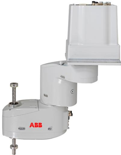
Der SCARA IRB 910INV ist schnell, präzise und kostengünstig. Er wird hängend montiert und bietet dadurch Platzersparnis und höhere Flexibilität bei Montageaufgaben.
