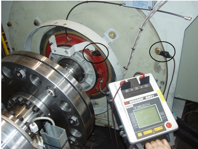
Illustration 28 Mesure de la résistance d'isolation d'un palier à roulement
