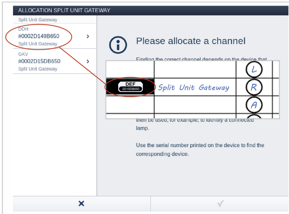
Fig. 7: Identificación mediante el número de serie
