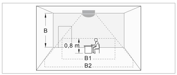
Fig. 13: Detection ranges of Busch-Presence detector mini KNX / Busch-Presence detector mini Premium KNX
